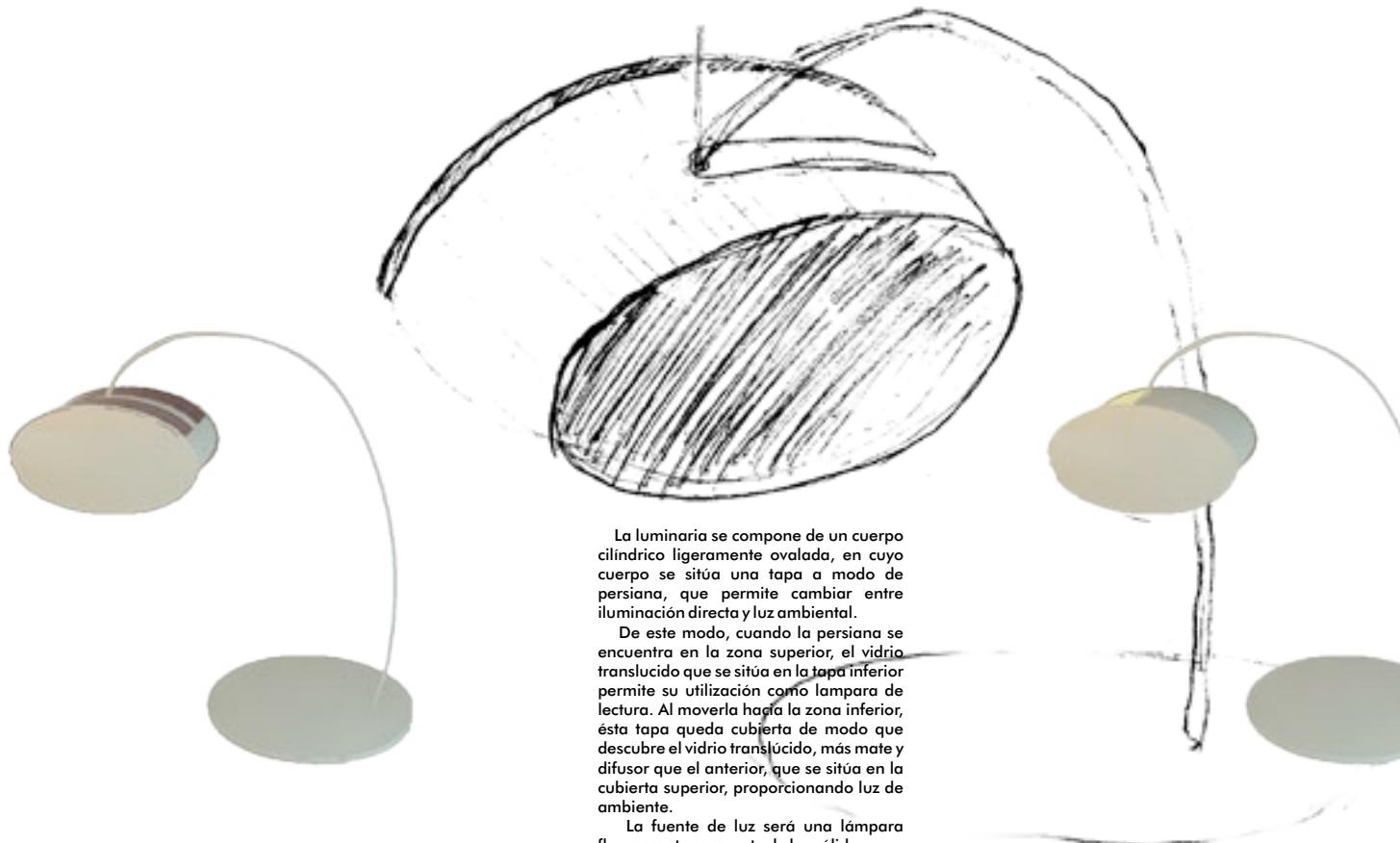
La luminaria se compone de un cuerpo cilíndrico ligeramente ovalada, en cuyo cuerpo se sitúa una tapa a modo de persiana, que permite cambiar entre iluminación directa y luz ambiental.
